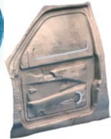
Pressad bildörr av magnesiumplåt från Volkswagen
